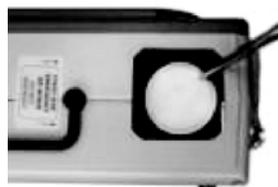
Entfernen Sie den Scheibenfilter mit der Klemme oder einer Pinzette, und ersetzen Sie ihn durch einen neuen, sauberen Filter. Stellen Sie sicher, dass der Filter flach auf dem Rand in der entsprechenden Aussparung aufliegt.
